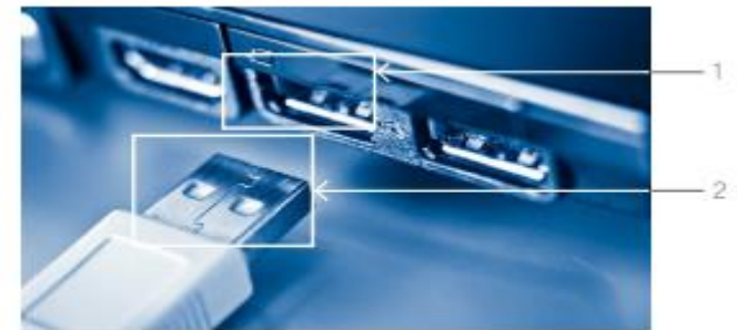
Figuur 1: Poort (1) en aansluiting (2)
